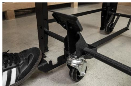
Ábra. 11. Pedál fent – az állvány a lábain áll, a kerekek pedig fel vannak emelve.
